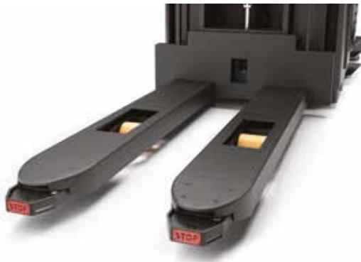
Capteurs mécaniques en bout de fourches pour permettre le travail en lignes de stockage compactes
