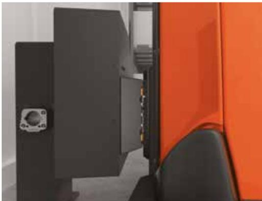
Les modèles Autopilot équipés de batteries lithium-ion vont se recharger automatiquement lorsqu'aucune tâche ne leur est assignée. Ce système de recharge rapide leur permet de fonctionner en continu et supprime les salles de recharge spécifiques et les interventions manuelles. De plus, les batteries lithium-ion sont économes en énergie (jusqu'à 30 % par rapport aux batteries au plomb) et réduisent de manière significative les émissions de CO2.
