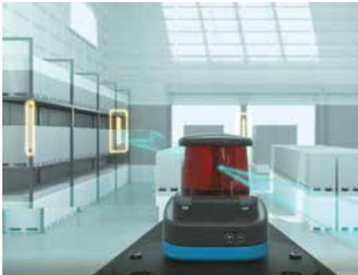
La navigation laser par réflecteurs est une méthode qui consiste à ajouter des repères très visibles (réflecteurs) dans l'environnement. L'installation de ces réflecteurs dans l'entrepôt permet au scanner de navigation de définir sa position en fonction de la distance par rapport aux réflecteurs. Cette technique est très robuste, particulièrement appropriée aux environnements vastes sans repères.
