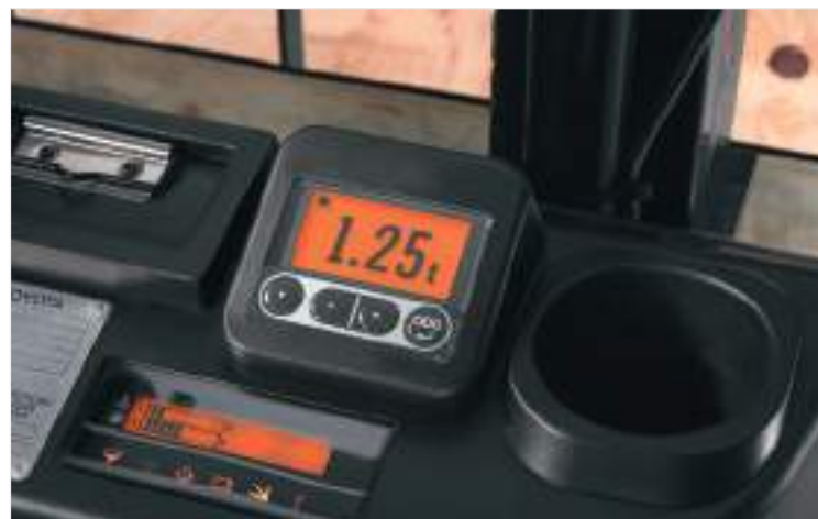
Le contrôleur de charge évite toute surcharge dangereuse sur les fourches
