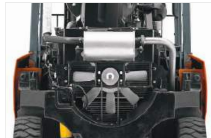
Les systèmes de refroidissement hautement efficaces garantissent un niveau de performance constant en toutes circonstances
