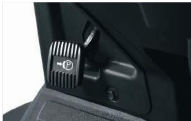
Le frein de parking négatif automatique de série permet d'appliquer les freins dès que le chariot est immobile sans dépense d'énergie (il fonctionne aussi moteur coupé). Cela augmente la sécurité lors des manipulations de palettes en hauteur et permet des opérations sur rampe simplifiées.
