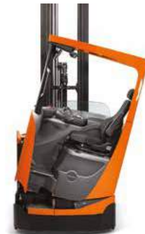
Ergonomie et sécurité renforcées avec la cabine inclinable : réduction des troubles musculo-squelettiques (par exemple tensions cervicales) du cariste et amélioration de la visibilité de la charge à grandes hauteurs
