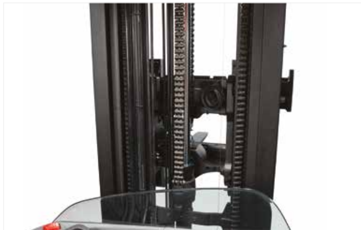
Le tablier porte-fourches à ouverture frontale avec déplacement latéral intégré offre une excellente visibilité frontale
