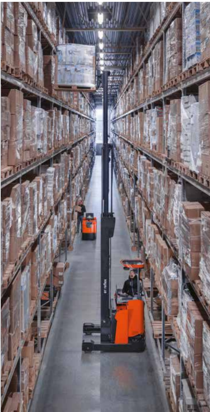
Le tablier porte-fourches à ouverture frontale avec déplacement latéral intégré offre une excellente visibilité frontale
