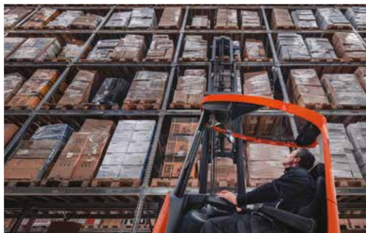
Ergonomie et sécurité renforcées avec la cabine inclinable : réduction des troubles musculo-squelettiques (par exemple tensions cervicales) du cariste et amélioration de la visibilité de la charge à grandes hauteurs
