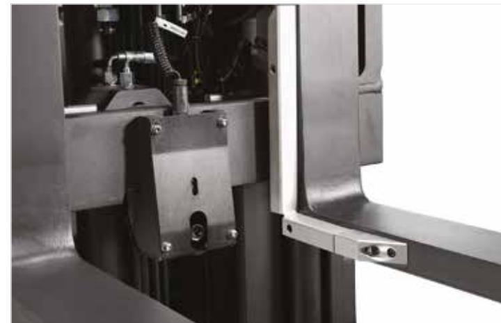
Le laser de fourches en option facilite le positionnement des fourches devant les palettes. Réduction des coûts liés aux dommages matériels et productivité élevée sont au rendez-vous
