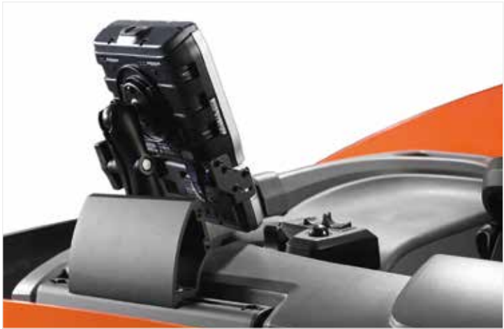
Rail de fixation E-bar pour équipements auxiliaires (option)
