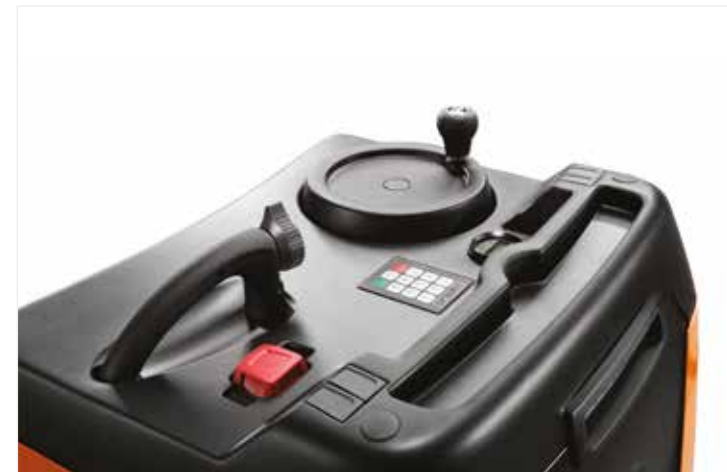
Petit volant de direction et accès par code PIN
