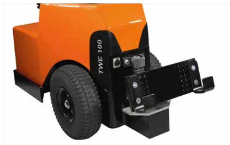
L'accrochage de la charge est facile, grâce au choix de crochets et raccords proposés
