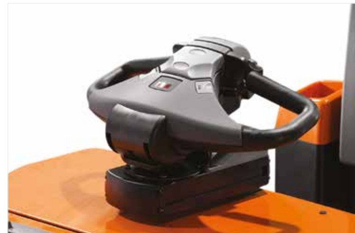
Système de commande E-man déplaçable d'un côté ou de l'autre du chariot pour faciliter « l'accompagnement à pied »
