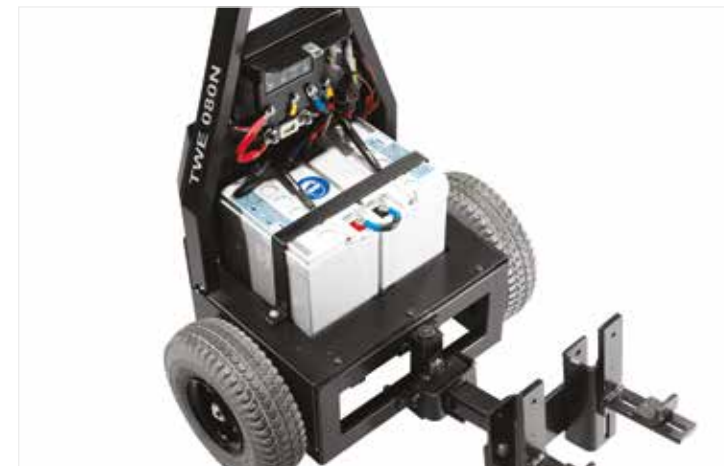
Les batteries au gel sans entretien équipent de série les modèles TWE080N
