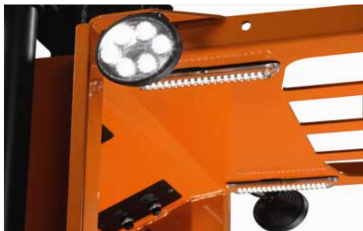
Les phares de travail à LED offrent un éclairage puissant et efficace
