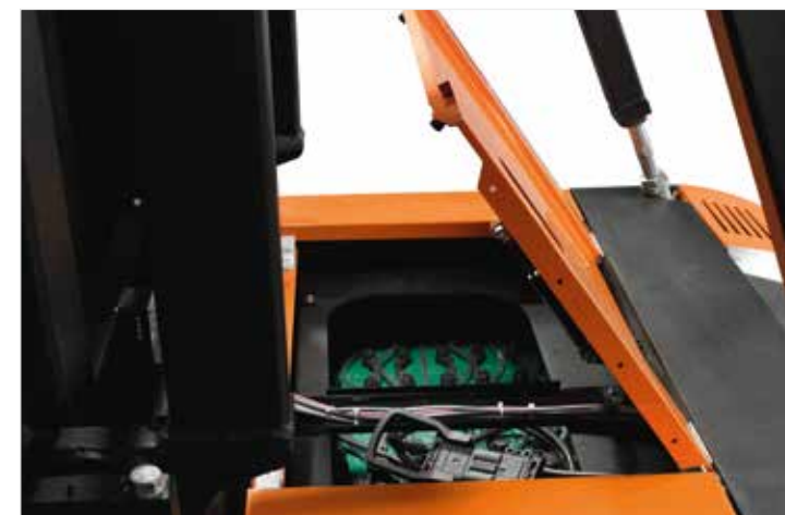
Accès aisé à la batterie pour sa mise en charge
