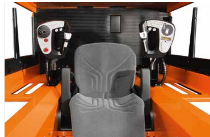
Le panneau de commandes divisé en deux parties facilite la saisie des palettes par le cariste lors des opérations de préparation de commandes
