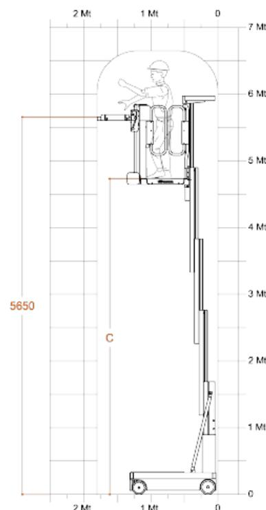
\* Charge maximale Vu que le poids de la plate-forme plus le chargement maximum sur le panier sont complètement distribué sur un côté de la plateforme (le chargement totalement asymétrique).
